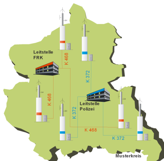
Abb. 2 Parallel betriebene Funksysteme in einem Kreis
