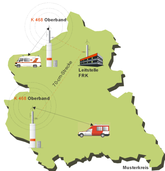
Abb. 57 Gleichwellenfunk im 4-m-Wellenbereich
